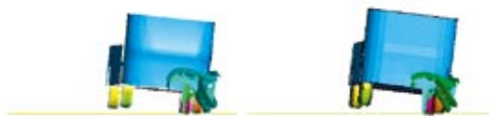
Figure 8 : vues de la simulation. A gauche, sur le modèle de barrière DE2 (largeur 0,8 m), à droite sur la solution DEe2 600 (largeur 0,6 m) finalement retenue (comparaison pratiquement au même moment du déroulement du choc)
